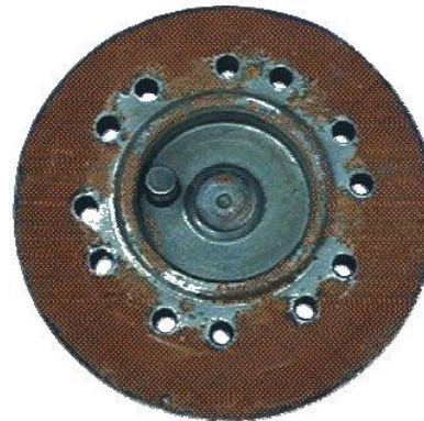
Corrosão por água em componentes da bomba de combustível
