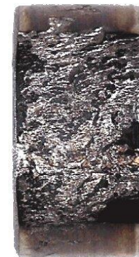
Corrosão por água em componentes da bomba de combustível
